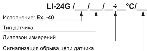
**Пример:** Преобразователь LI-24G, датчик – термометр сопротивления Pt100, диапазон 0...200°C, сигнализация 21,5 мА
