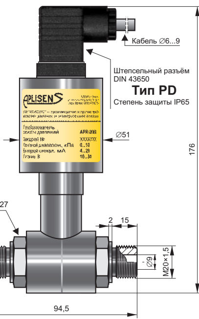
APR-2000PD с присоединительным устройством типа P (для подвода импульсных трубок)
